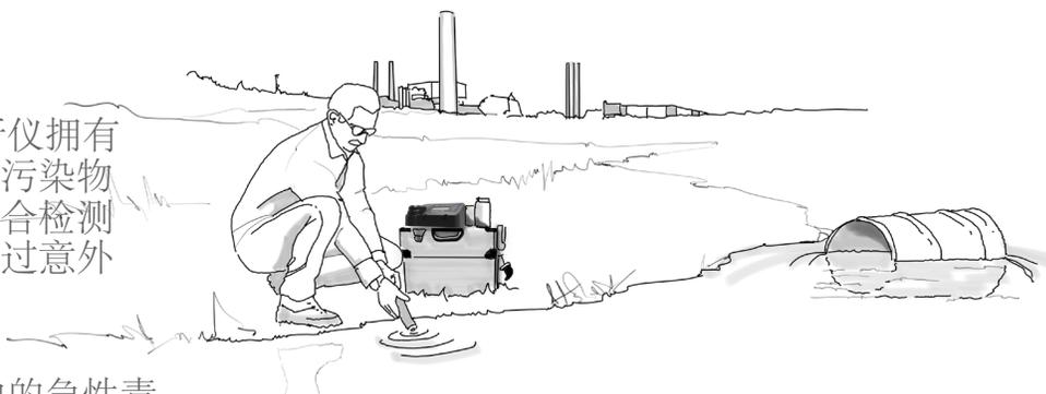
Microtox® FX 可用于测试水中的急性毒性和 ATP（三磷酸腺苷）含量，是一款适用于对饮用水水源和自来水终端生物毒性进行快速、精确测定的理想仪器。
